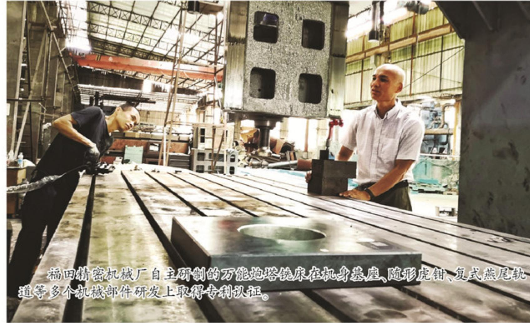
福田精密机械厂自主研发的万能炮塔铣床在机身基座、随形虎钳、复式燕尾轨道等多个机械部件研发上取得专利认证。
