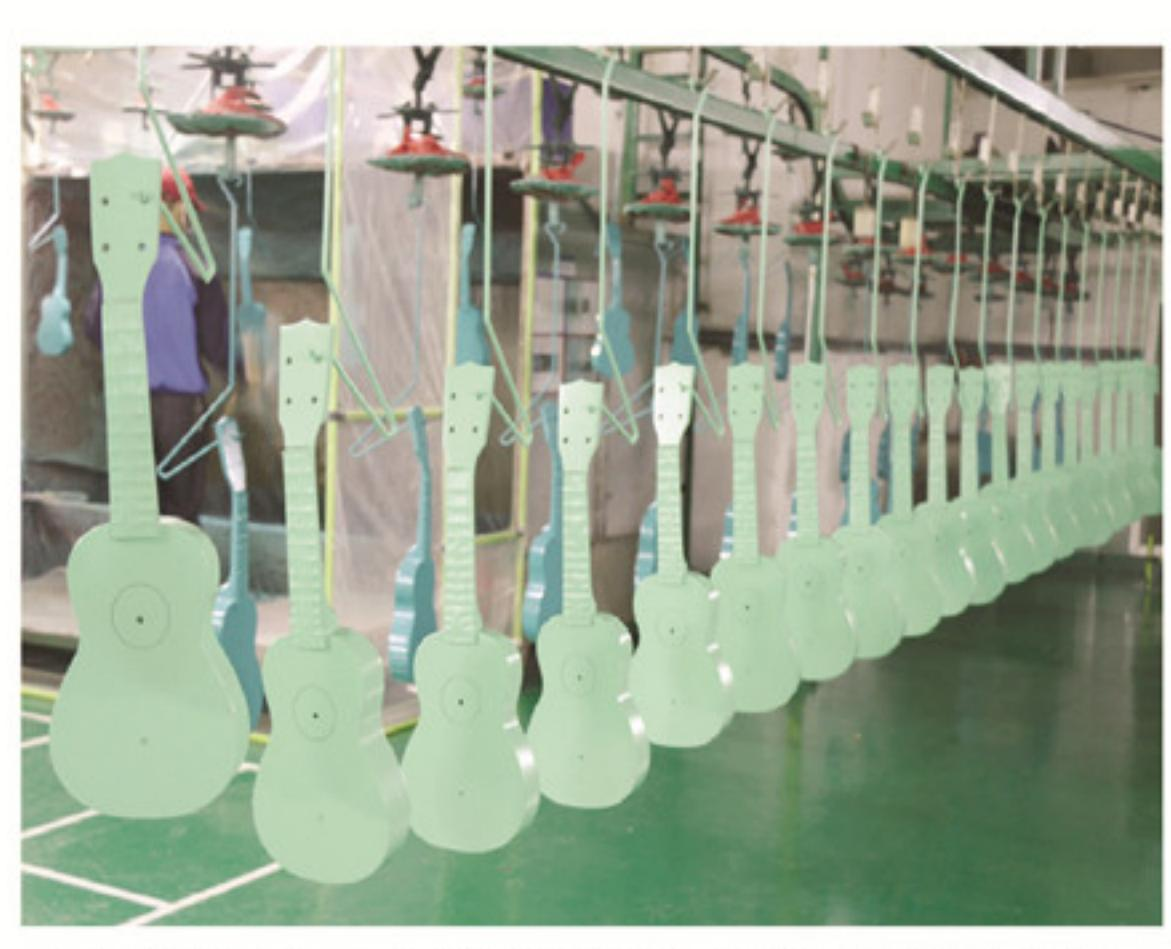
在生产车间内,尤克里里正在通过自动生产线进行喷漆。
