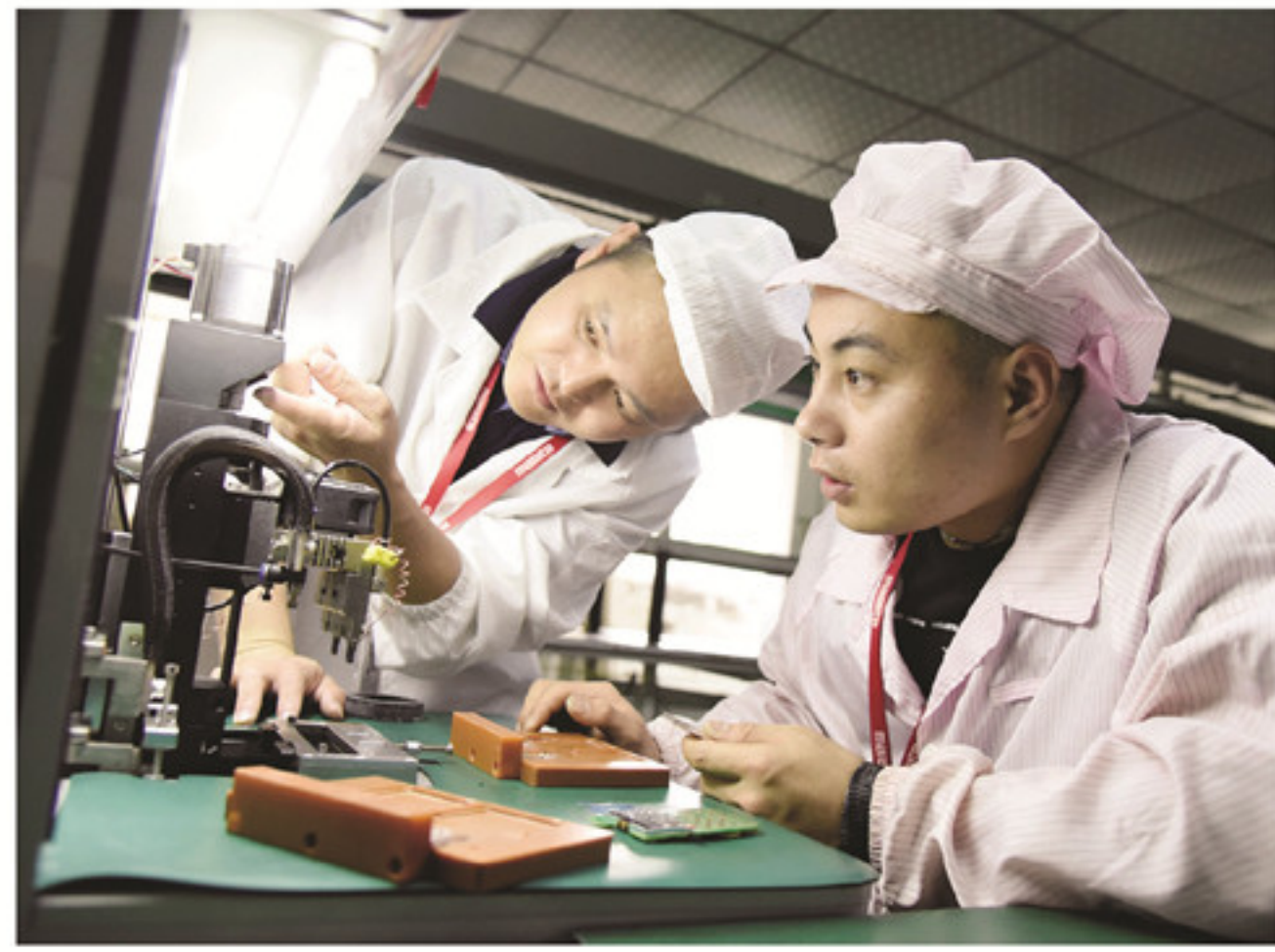
陈海洋(左)正在指导员工操作自动压焊设备,对平板电脑线路板进行焊接。
