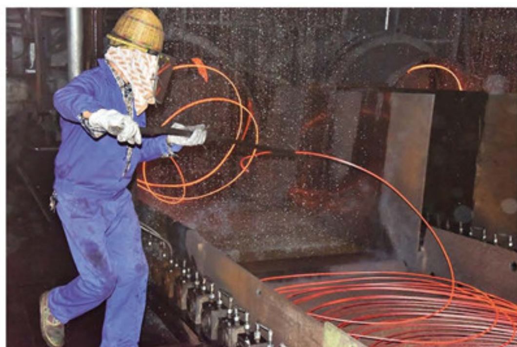
福建闽星集团线材厂车间内,工人正在吐丝机前作业。
