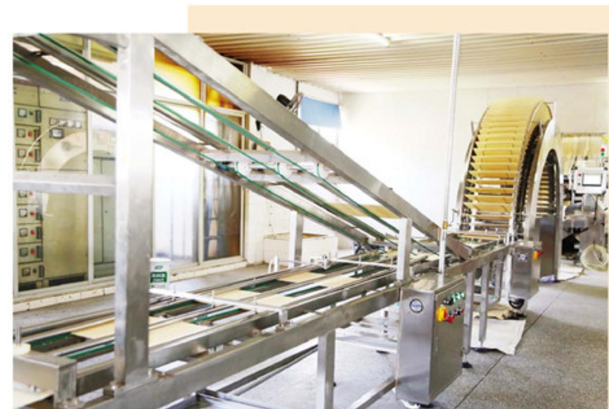
新的威化饼干自动化生产线,从理料、成型到包装,全部实现自动化。
